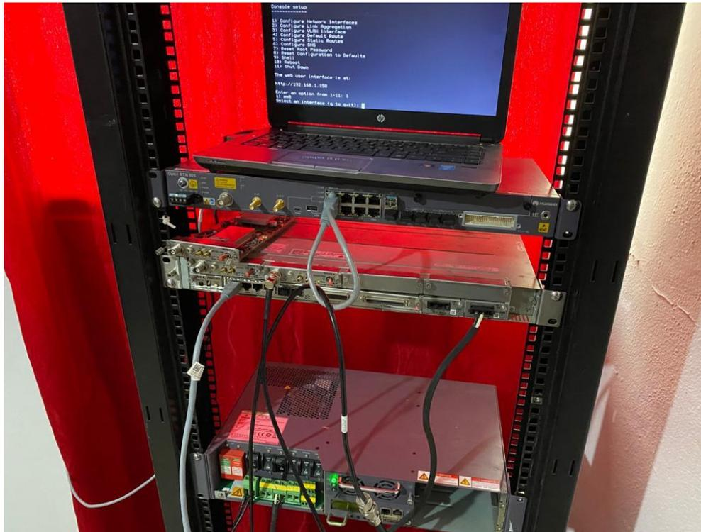
Maqueta de radioenlace punto a punto con IDUs Huawei y NEC, alimentadas por un rectificador de 110V AC a -48V DC, de esta manera se pudo analizar y validar el tipo de capacidad de estos equipos utilizados por ambas operadoras en sitios reales de telefonía en Nicaragua, además del acceso que facilita mi trabajo para la instalación, configuración y puesta en marcha de estos dispositivos.
