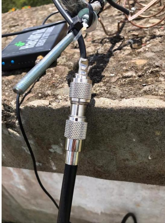
Haciendo uso de cable coaxial como principal elemento en este diseño de antena, también se acoplaron sus respectivos conectores con el fin de sustraer y monitorear los datos recibidos por la antena. Por ende, y a como se puede apreciar en la imagen, se ha hecho uso de conectores RG-58 macho y hembra, asimismo conectores machos SMA y su cable RG-174.
