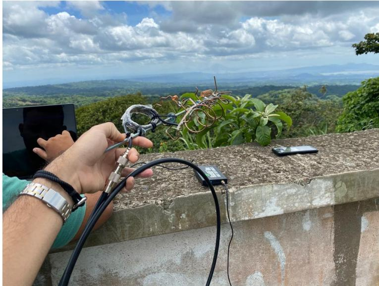
Durante esta investigación, se diseñó un modelo de antena fractal capaz de funcionar dentro de un rango de frecuencias muy amplio, en una visita a un sitio con una excelente línea de vista hacia el centro de Managua, se realizaron muestreos de los parámetros conseguidos con la antena desde los 144.800MHz hasta los 7.940GHz, documentando los valores mediante el dispositivo HackRF que a su vez decodifica y muestra los datos a través de un software compatible con el dispositivo.
