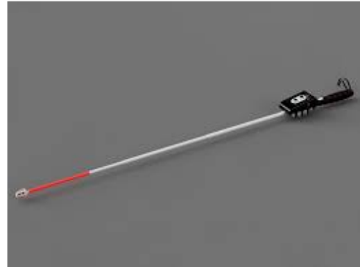
Figura 2: Bastón blanco electrónico (arduino uno) Fuente:(gallery.autod esk.com)
